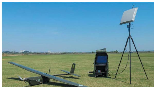
Figura 9: Exemplo de Aeronave Remotamente Pilotada e sua Estação de Controle de Solo.
