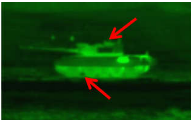
Figura 4: Assinatura térmica do carro de combate médio T-55. Fonte: Brasil (2014).
