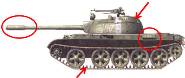
Figura 3: Características chave de identificação do carro de combate médio T-55. Fonte: Brasil (2014).
