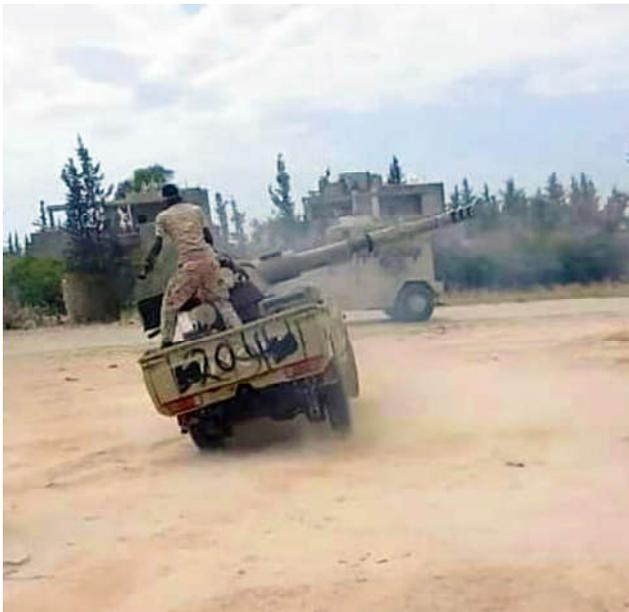
Figura 6: Líbia 16 de maio de 2019. *Technical* Toyota Land Cruiser armada com canhão Engesa EC-90 realizando disparo próximo a Trípoli. Notar o tiro lateral e a estabilidade do veículo.
