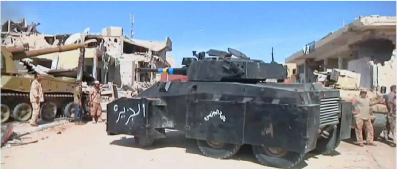
Figura 5: EE-9 Cascavel M3-S2 (Líbia) todo pintado de preto e com saias de proteção laterais, frontal e traseira, confeccionadas em chapas de aço, as quais podem ser abertas para acesso aos pneus, operando na cidade de Sirte em 22 de novembro de 2016. O interessante é que sua mobilidade não foi prejudicada. Nas laterais pintados em branco: Batalhão Al-Jazira.
