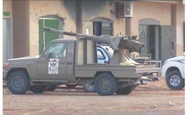
Figura 7: *Technical* Toyota Land Cruiser armada com canhão Engesa EC-90 capturada em 11 de junho de 2020 em Sirte. Notar que recebeu algumas marcações de número sobre o emblema na porta.
