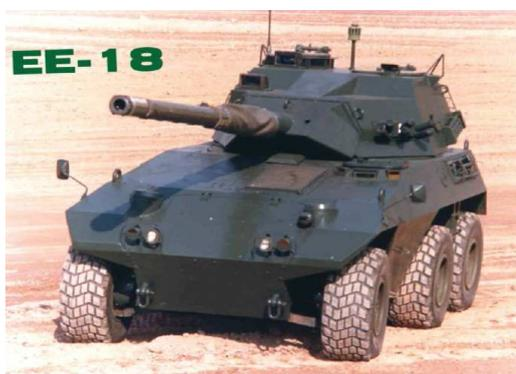
Figura 4: EE18 - SUCURI – Viatura Caça Tanque com canhão 105 mm.
