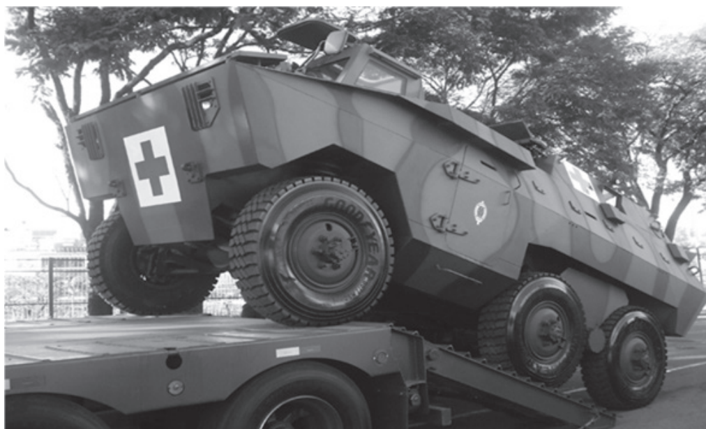
Figura 1 – Urutu EE-11 ENGESA modificado para versão ambulância (AGSP, 2015)
