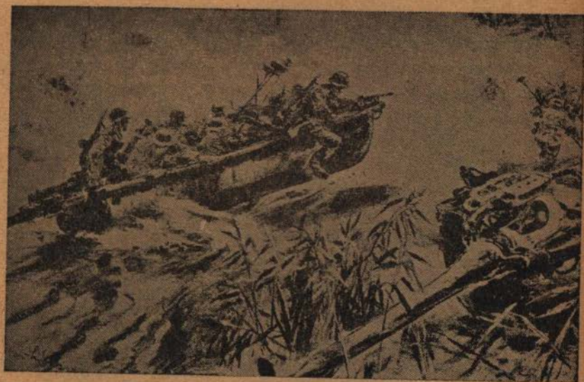
Travessia do Reno, em um bote tempestade, transportando um destacamento de assalto. Note-se o motor de popa e as cargas alongadas com os soldados de Engenharia.
