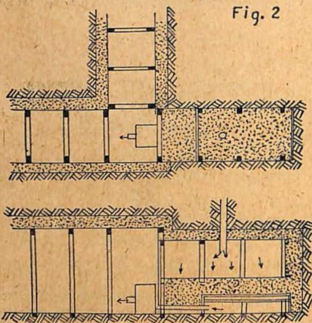
A chaminé poderá ser em tubo de ferro ou em madeira, porém, perfeitamente aderente ao terreno, para evitar as infiltrações de gás.
