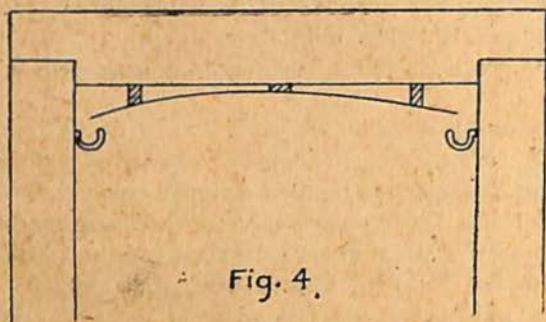
Fixam-se as chapas sôbre a verga, no caso da figura 4, arqueando-as ligeiramente, afim de escoarem as águas, para duas calhas longitudinais, presas às ombreiras.
