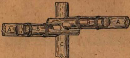
Fig. — 27. — Disposição dos montantes de encontro secundários sobre a peça de ponte central.
