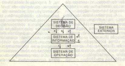
(a) O Sistema de Decisão fornece informação ao Sistema de Informação, do Tipo "OR-DEM A TRANSMITIR", constituindo-se em decisão que indica ação a realizar; é a mensagem de execução. Exemplo: uma ordem de fabricação; ou uma or-
