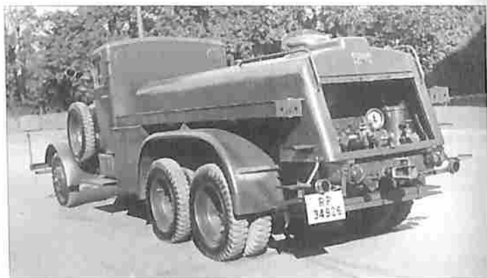
Fig. 12 - Viatura Cisterna para Transporte de Combustível (Krupp - Henschel - Daimler-Benz)
