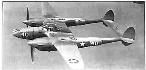
Lockheed P-38F Lightning da USAAF. O caça bimotor orgânico do 339º Fighter Squadron era armado com dois canhões 20mm e quatro metralhadoras .50
