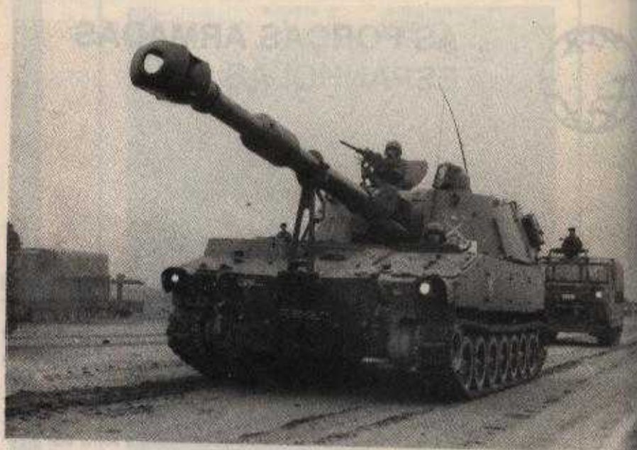
Um dos obuses autopropulsados de 155mm M-109A da Artilharia da Divisão Blindada "Brunete"
