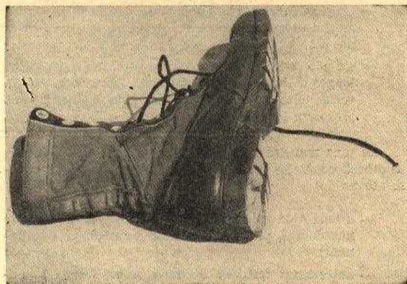
Fig. n.º 2 — Podemos ver o desgaste sofrido pelo salto de um dos coturnos norte-americanos, que foi utilizado diariamente, durante 3 anos e 8 meses por um dos instrutores do COSAC, que comprovam a alta qualidade do material
