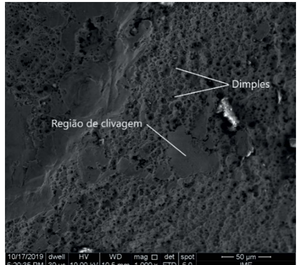
Fig. 5 – Micrografia aproximada, obtida por MEV para a fratura do aço em estudo submetido a tração.
