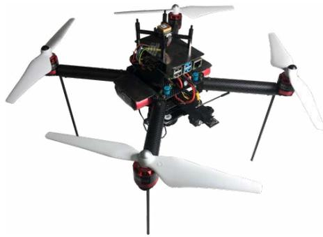
**Fig. 10** – ARP de 330mm construída para desempenhar o papel de ARP estacionária.
