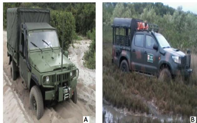
**Fig. 15** – Viatura Marruá em teste de trafegabilidade em solo arenoso típico de região litorânea (A) e Viatura Hilux em solo típico de mangue (B). **Fonte:** [2]
