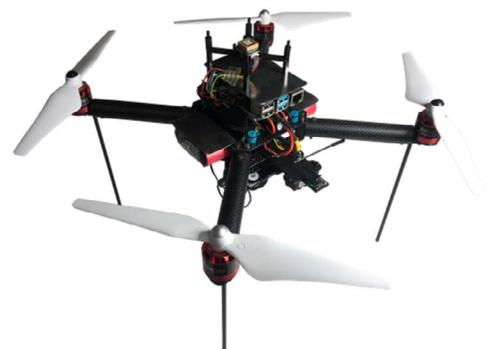
**Fig. 10** – ARP de 330 mm construída para desempenhar o papel de ARP estacionária.
