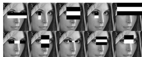
Fig 3: Varredura da imagem através das features retangulares, extraído de [7].
