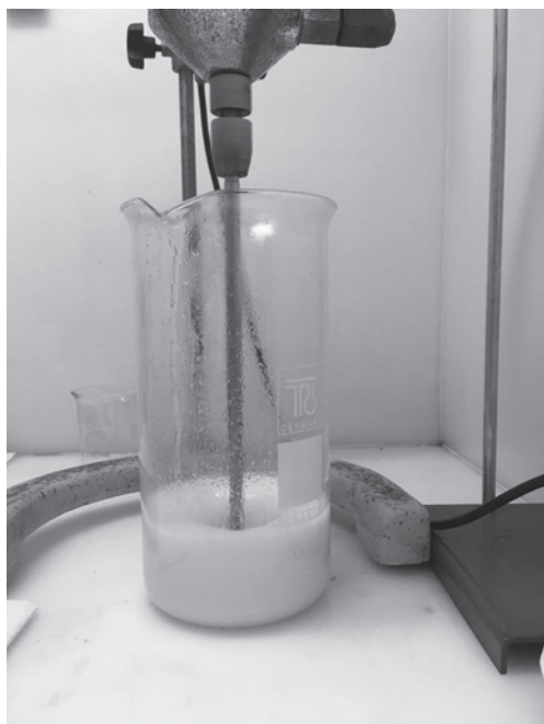
Fig 2 – Sistema reacional para síntese de óleos vegetais epoxidados
