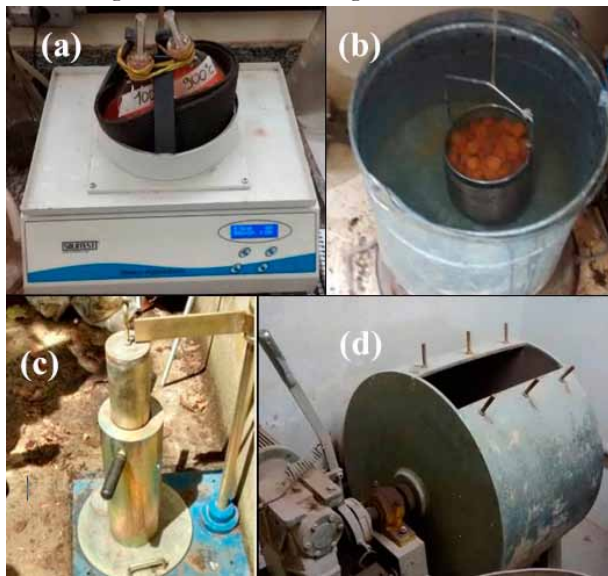
Fig. 11 – Exemplos de ensaios de caracterização física e mecânica nos agregados: (a) Perda de massa após fervura; (b) Absorção de água; (c) Perda ao choque Treton e (d) Desgaste por Abrasão Los Angeles.
