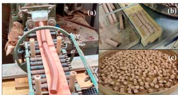
Fig. 9 – (a) Extrusão à vácuo; (b) corte das barras e (c) aspecto dos agregados durante o processo de secagem.
