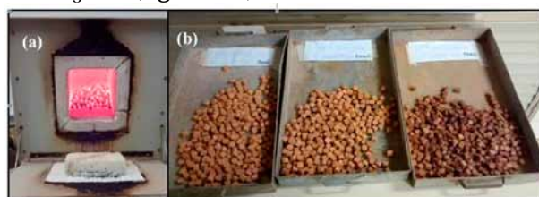
Fig.10 – (a) Calcinação em forno mufla e (b) obtenção das amostras em três diferentes patamares de temperaturas – 900, 1000 e 1100 °C.
