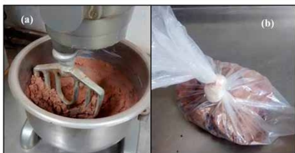
Fig. 8 – Sequência de processos necessários à fabricação dos agregados em laboratório: (a) Umidecimento e mistura; (b) homogeneização da massa na câmara úmida.
