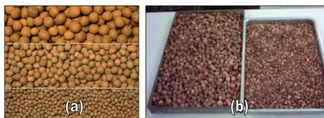
Fig. 3 – (a) Agregados de argila expandida produzidos pela empresa CINSITA; (b) Agregados calcinados antes e após redução por britagem [10], [7].
