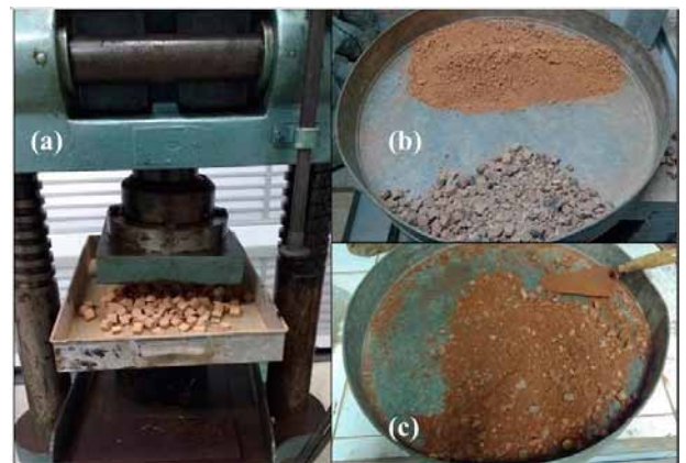
Fig. 12 – (a) Britagem dos agregados produzidos; (b) e (c) antes e depois da mistura solo laterítico – agregado calcinado.
