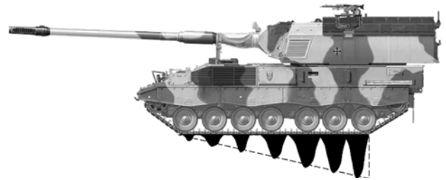
Fig. 4 – Distribuição de pressão linear crescente– PzH-2000 [14].
