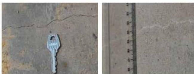
Fig. 7 – Regeneração de trincas 1mm (a) 24 horas e (b) 48 horas após a compactação.
