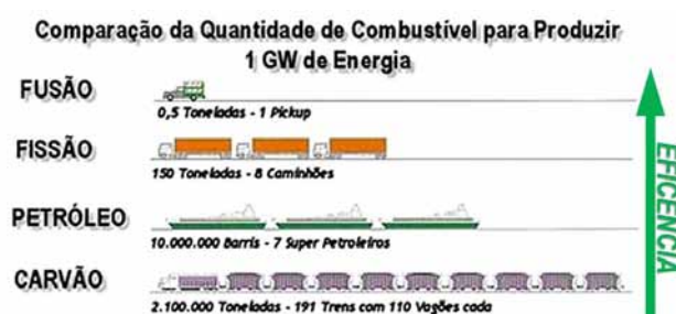
Fig. 5 – Comparativo das eficiências dos combustíveis utilizados para gerar eletricidade. Fonte: [6] e [7].
