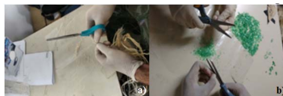
Fig. 2 - Fibras sendo cortadas (a) e policarbonato sendo picado (b).
