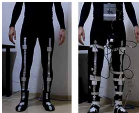
Fig. 4 – Esquerda marcadores da posição dos sensores; direita dispositivo montado no corpo humano.
