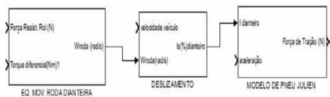
Fig. 6 – Diagrama de blocos do conjunto roda/pneu para TJ em um 2º nível.
