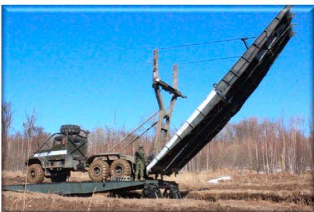
Fig 8 – Viatura lançadora de pontes TMM-3. Fonte: ODIN – TRADOC (US Army).
