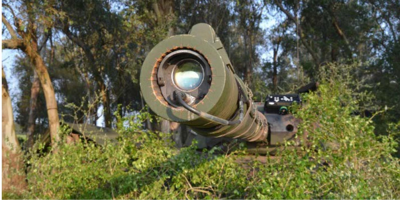
Figura 5 - Tubo *Leopard* 1A2 equipado com emissor *laser*
