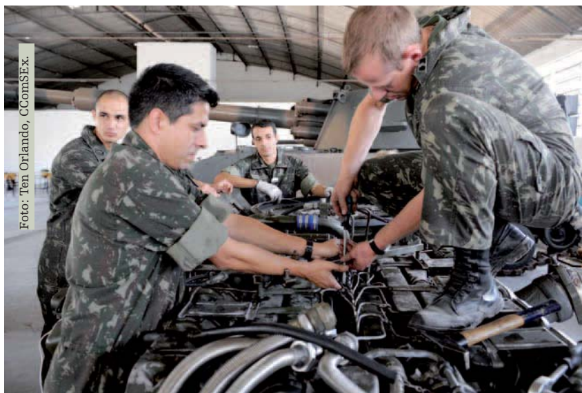
Foto: Ten Orlando, CComSEX. Apoio ao Material: militares do Pq R Mnt/3 em atividade de manutenção de um motor de viatura blindada.2010.
