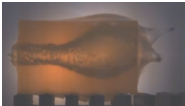
Fig 1 - Munição 7,62 X 51 M80 FMJ – efeitos em gelatina balística, observáveis imediatamente após transfixação. Fonte: https://www.youtube.com/watch?v=sGYF8DTLcj4 .
