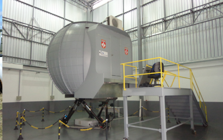
O Simulador de Helicópteros Esquilo e Fenec (SHEFE) atende à formação continuada dos pilotos militares. Pode ser alugado para o treinamento de pilotos civis reduzindo os custos do investimento realizado.
