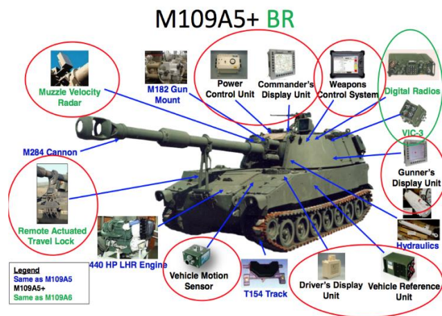
FIGURA 2 - Sistemas embarcados do M109 A5 Plus Br. Fonte: BAE SYSTEMS (2012).
