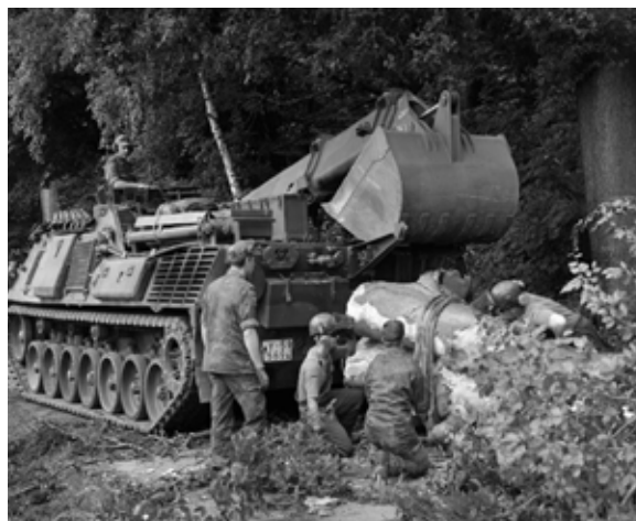
Figura 9: Tronco de árvore preparado para ser rebocado por VBE Eng. Fonte: DW, 2013.
