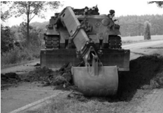
Figura 6: VBE Eng escavando em estrada para canalizar água. Fonte: Gatterman, 2013
