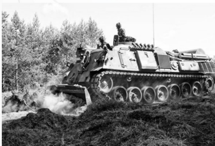
Figura 8: VBE Eng construindo aceiro. Fonte: RP-OnLine, 2018.
