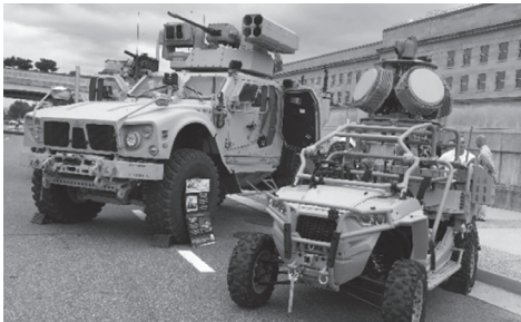
Figura 1: Exemplo de Sistema de C-UAS Terrestre Móvel.
