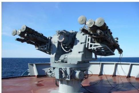
Figura 12: Lançadores IGLA duplos em torreta Gibka-R (plataforma naval).
