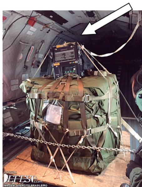
Figura 2 – Carga equipada com o sistema de precisão *Sherpa Ranger 700*
