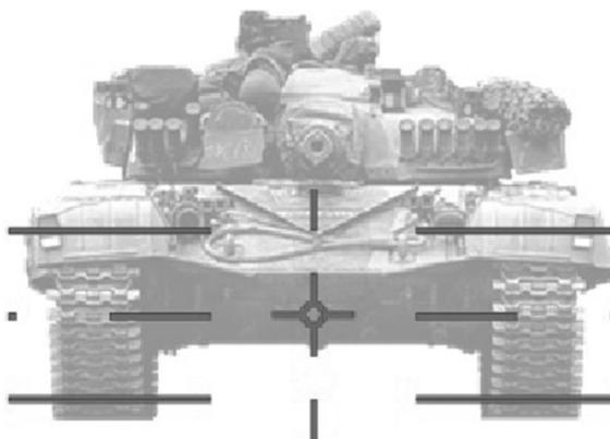
Fig. 5 – Proposta de técnica de tiro específica para alvos que estejam sendo engajados em ambientes operacionais sob influência de refração noturna
