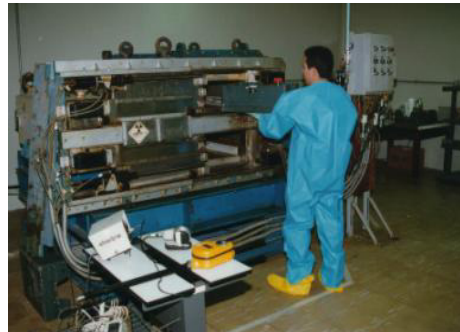
Figura 3 – Irradiador de céσιο disponível no IPE.
