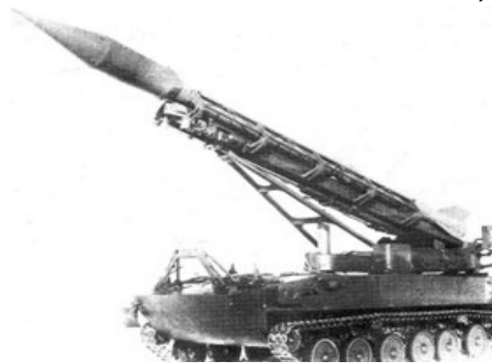
Figura 2 – Unidad de lanzamiento del sistema Luna 3R10 con ojiva nuclear táctica
