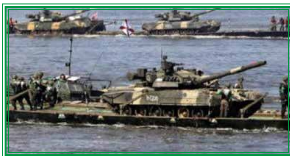
Figura 1 – Ponte modular pesada Fonte: Grau e Bartles (2016)
