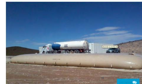
Figura 1 - Bladders usado para armazenamento de água
