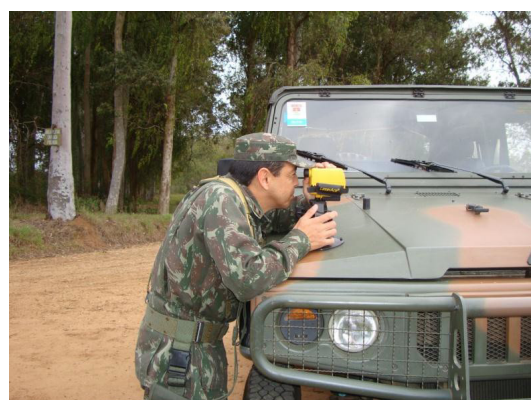
Foto 15 - Telêmetro laser MDL Laser-Ace3 sendo utilizado no terreno;
