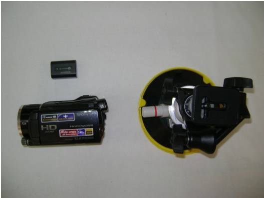
Foto 07 – Câmera de vídeo Sony e seus componentes (incluindo a ventosa de fixação);
