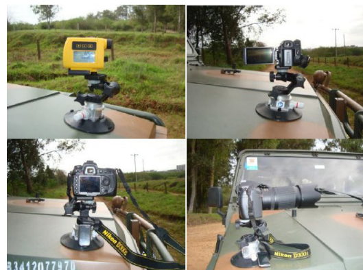
Foto 18 – Equipamentos conectados às suas respectivas ventosas;
