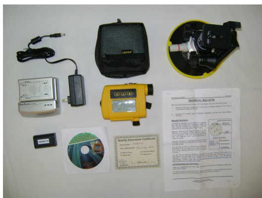
Foto 09 – Telêmetro laser MDL LaserACE 3-D e seus componentes;
