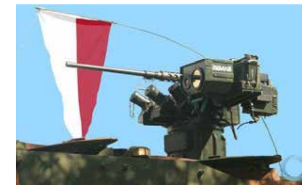
Figura 10- Foto torre REMAX, junto com a Mtr.50 na VBTP Guarani.
