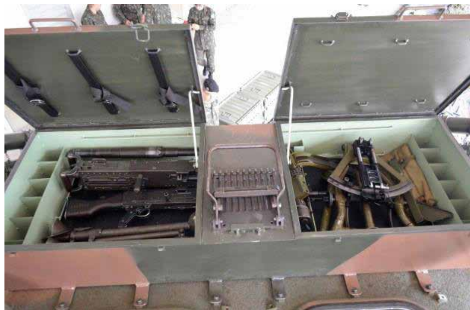
Figura 05- Compartimento de armazenamento de munição e material individual e coletivo.
