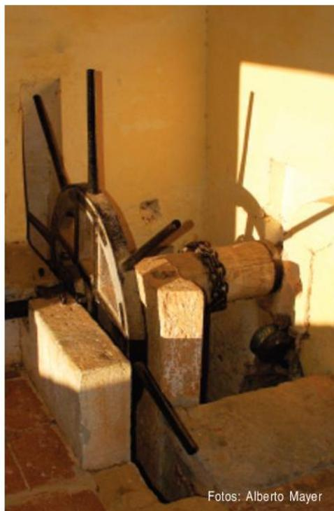
Mecanismo da ponte levadiça que permite a passagem ao reduto central
