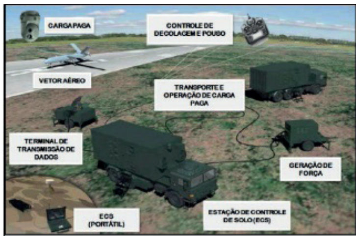
Figura 2 – Visualização dos módulos funcionais dos SARP da F Ter Fonte: MC EB20-MC-10.214 – Vetores Aéreos da Força Terrestre
