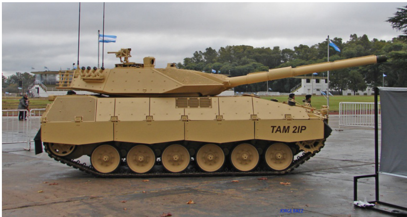
Figura 7: TAM 2 IP com múltiplas camadas de blindagem adicionais sobre o chassi e a torre.
