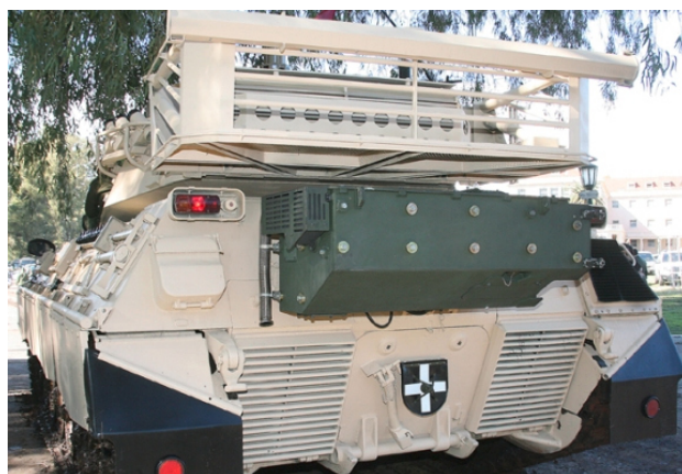
Figura 3: Unidade auxiliar de energia de 6 kVA diesel (cor verde) instalado na retaguarda do chassi do TAM 2C.
