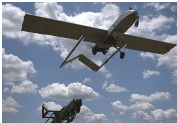
Figura 1: RQ-7B Shadow no momento do lançamento. Fonte: U.S. Army .
