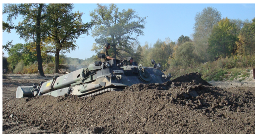
Figura 02: VBC Eng realizando a abertura de um espaldão para CC.
