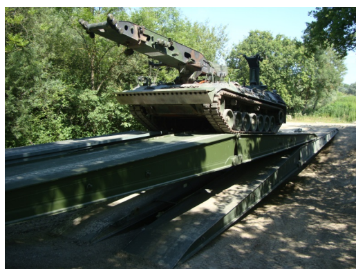
Figura 7: Ponte conjugada sobre um fosso anticarro.
